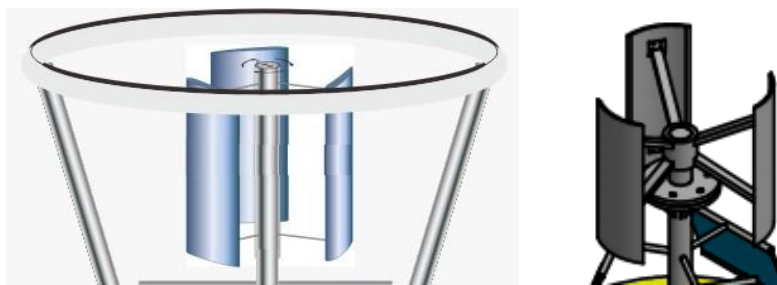
Gambar 5. Desain Turbin Angin pada Alat (Sumber: Desain Pribadi)
