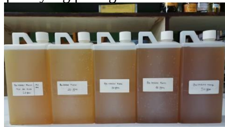
Gambar 4. Larutan Bioinhibitor Korosi Variasi Konsentrasi 10 – 50 ppm
