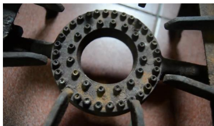
Gambar 7. Komponen Kompor Biogas yang Berkarat dan Bergumpal
