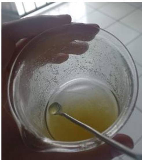
Lampiran 4. Hasil Sintesis Selulosa Dedak Padi dan NADES
